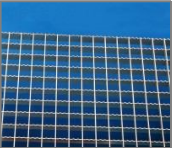
При наклоне площадок от 6 до 10° применяются решетки с зубчатыми несущими и/или поперечными полосами.
