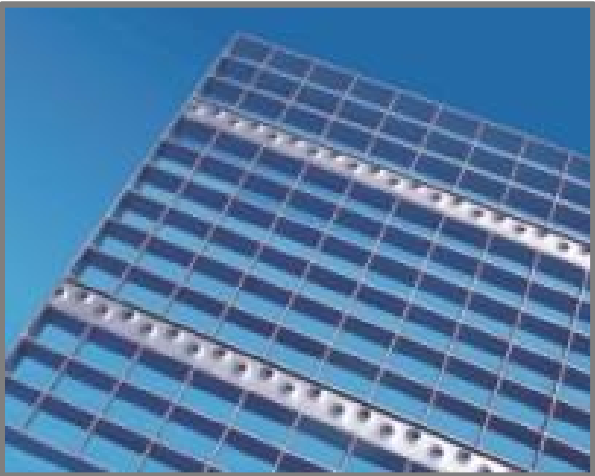
При наклоне площадок от 10 до 24° применяются противоскользящие планки по всей ширине решетки на расстояниях равных средней длине шага, т.е. около 600 мм.
